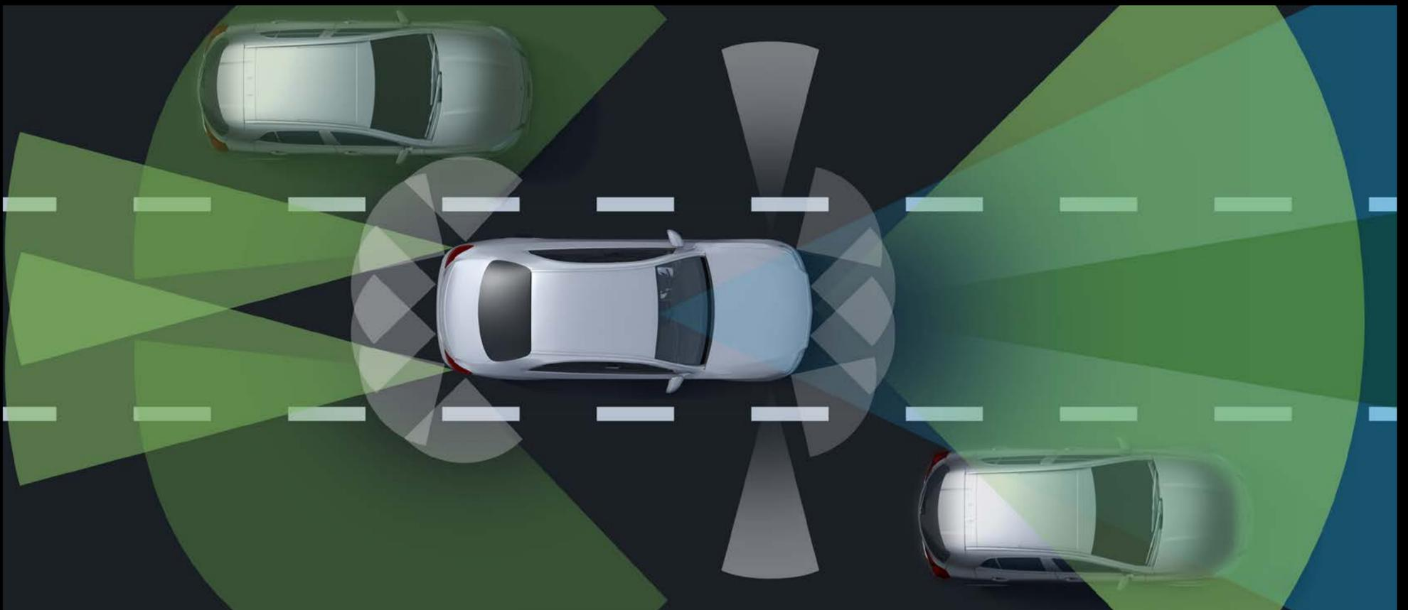
카메라, 레이더 및 초음파로 구성된 센서 시스템이 주변 환경을 분석하여 속도, 조향 제어 및 차간 거리 유지 등 필요 시점에 적합한 주행 보조 기능을 실행합니다. 코너, 원형 교차로, 나들목 또는 톨게이트 등의 환경을 고려하면서 이동하는 트래픽에 따라 운전자를 대신하여 제동 및 가속을 제어합니다. 충돌 위험이 있는 경우 먼저 시청각적 경고로 운전자에게 알리고, 필요시 자동으로 제동 기능을 실행합니다. 또한, 고속도로 혹은 차선 표시가 있는 일반 도로에서 차선을 벗어나는 경우 차량 방향을 수정하기 위해 시스템이 조향에 개입해 탑승자와 보행자를 보호하여 사고 위험을 줄일 수 있도록 도움을 줍니다. (기본사양)
