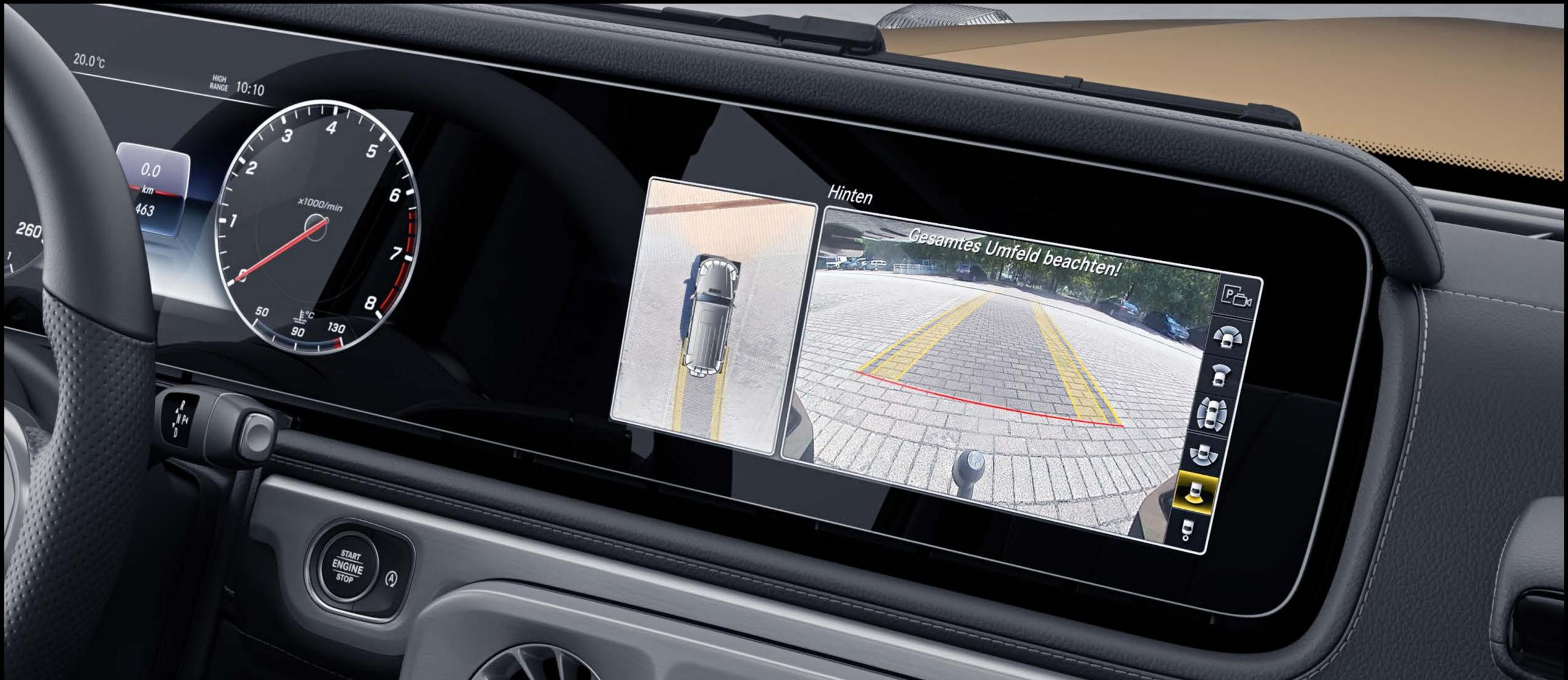
전후측면 및 범퍼에 포함된 12개의 초음파 센서와 액티브 주차 어시스트, 360° 카메라를 통해 보다 편리한 주차를 도와줍니다. 액티브 주차 어시스트는 차량의 표시, 조향, 가속, 제동 및 기어 변경을 지원하며, 디스플레이에 표시되는 360° 카메라는 다양한 각도의 뷰를 제공하여 차량의 앞, 뒤, 양옆을 모니터링할 수 있습니다. 조향 각도에 따른 가이드라인은 물론, 버드-아이-뷰를 통한 차량의 가상 조감도를 추가 표시하여 좁거나 까다로운 공간에서도 쉽게 주차 할 수 있도록 도와줍니다. (선택사양)
