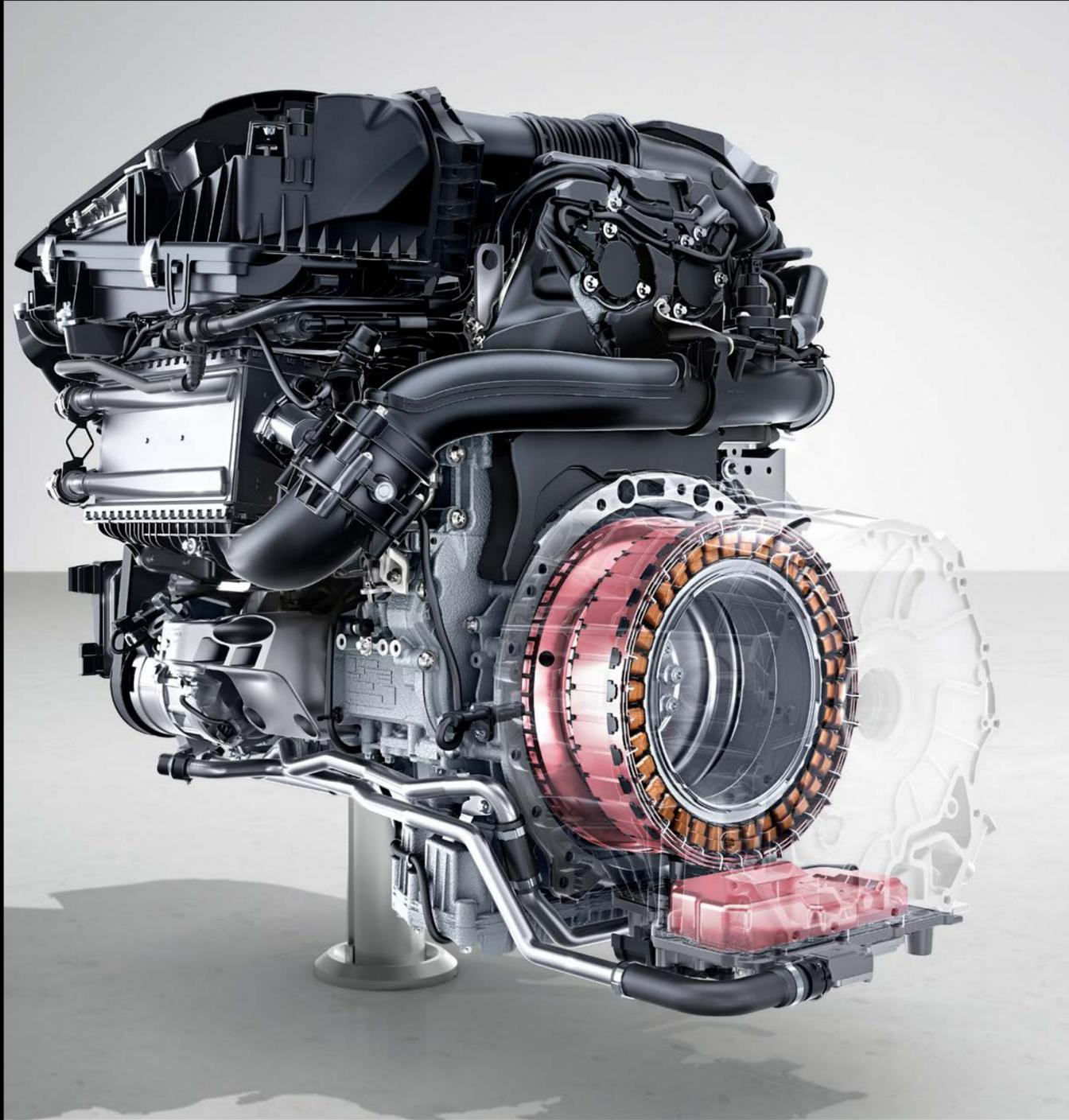
48V 마일드 하이브리드를 탑재한 4기통 가솔린 엔진 M254는 낮은 엔진 속도에서도 최상의 주행 성능을 자랑하며, 최적화된 연료 소비와 낮은 배기가스 배출량을 선보입니다. 2세대 통합 스타터-제너레이터(ISG)가 9G-Tronic 변속기와 결합되어 무게를 줄이는 동시에 내구성을 향상했으며, 190kW 파워 스테이지에서 약 30초 동안 20kW의 추가 출력을 지원합니다.
