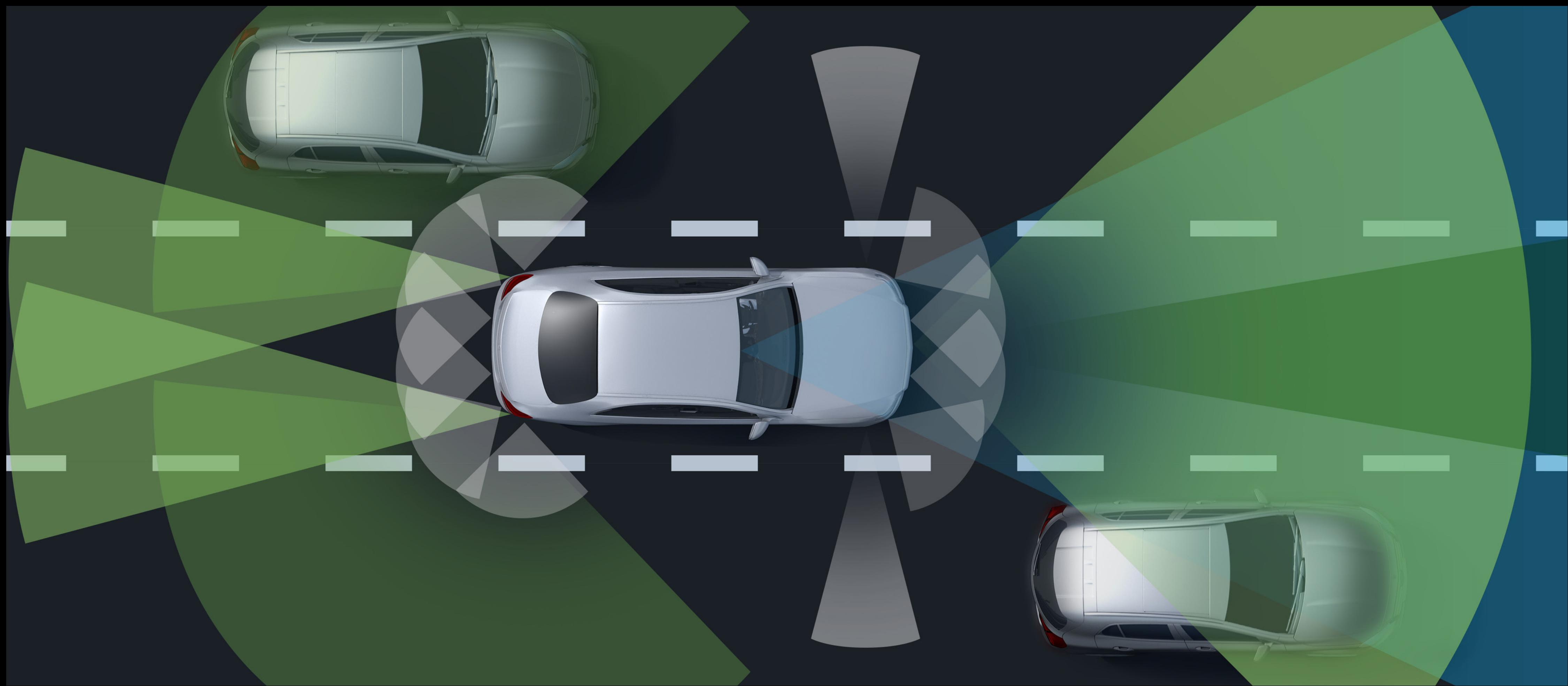
카메라, 레이더 및 초음파로 구성된 센서 시스템이 주변 환경을 분석하여 조향 제어 및 차간 거리 유지 등 필요 시점에 적합한 주행 보조 기능을 실행합니다. 코너, 원형 교차로, 나들목 또는 터널 등 환경을 고려하면서 이동하는 트래픽에 따라 운전자를 대신하여 제동 및 가속을 제어합니다. 충돌 위험이 있는 경우 먼저 시청각적 경고로 운전자에게 알리고, 필요시 자동으로 제동 기능을 실행합니다. 또한, 고속도로 혹은 차선 표시가 있는 일반 도로에서 차선을 벗어나는 경우 차량 방향을 수정하기 위해 시스템이 조향에 개입해 탑승자 와 보행자를 보호하여 사고 위험을 줄일 수 있도록 도움을 줍니다. (기본사양)
