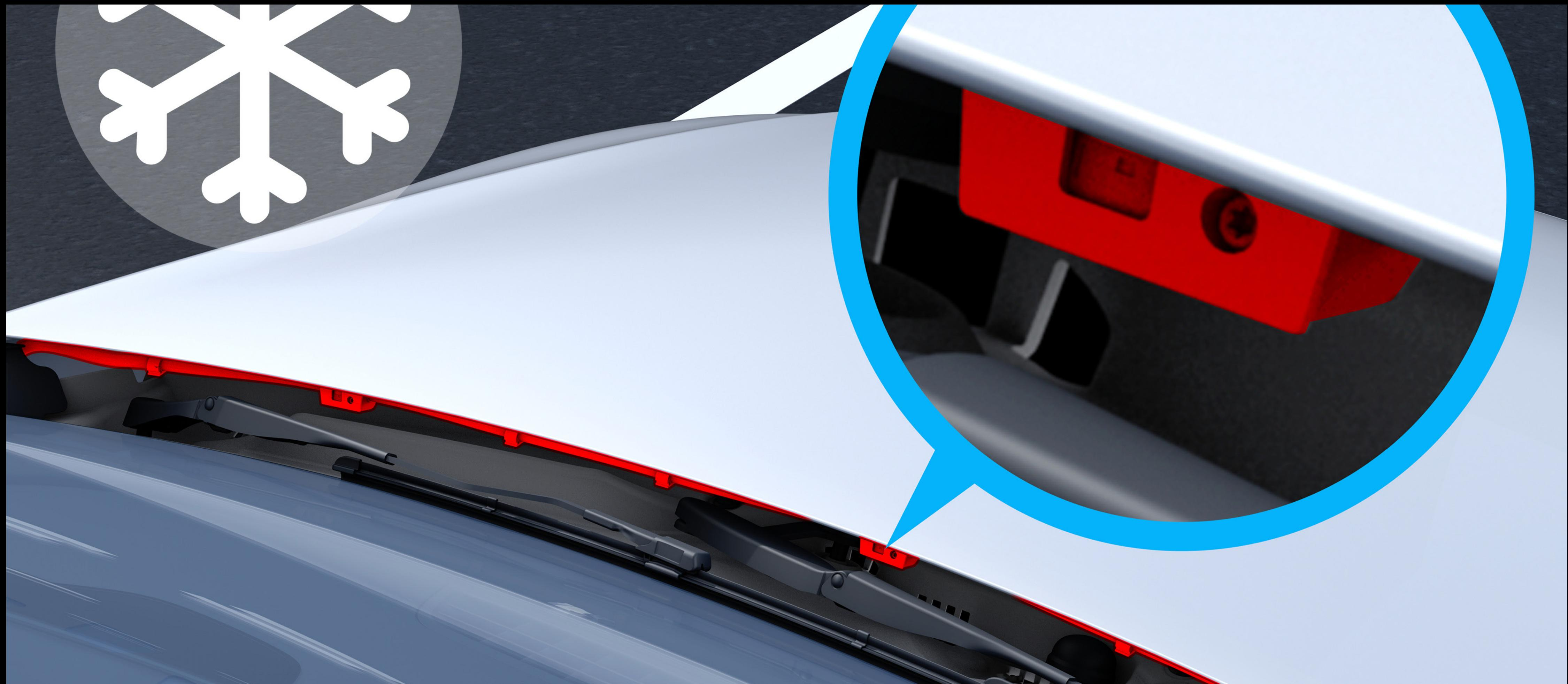
온열 윈드스크린 워셔 시스템은 추운 날씨에도 선명한 시야와 안전한 운전을 보장합니다. 특히  $5^{\circ}\text{C}$  이하의 온도에서 에너지 효율적인 모드로 작동하여 앞유리를 결빙 현상이 발생하지 않는 최상의 상태로 유지 시켜줍니다. (기본사양)
