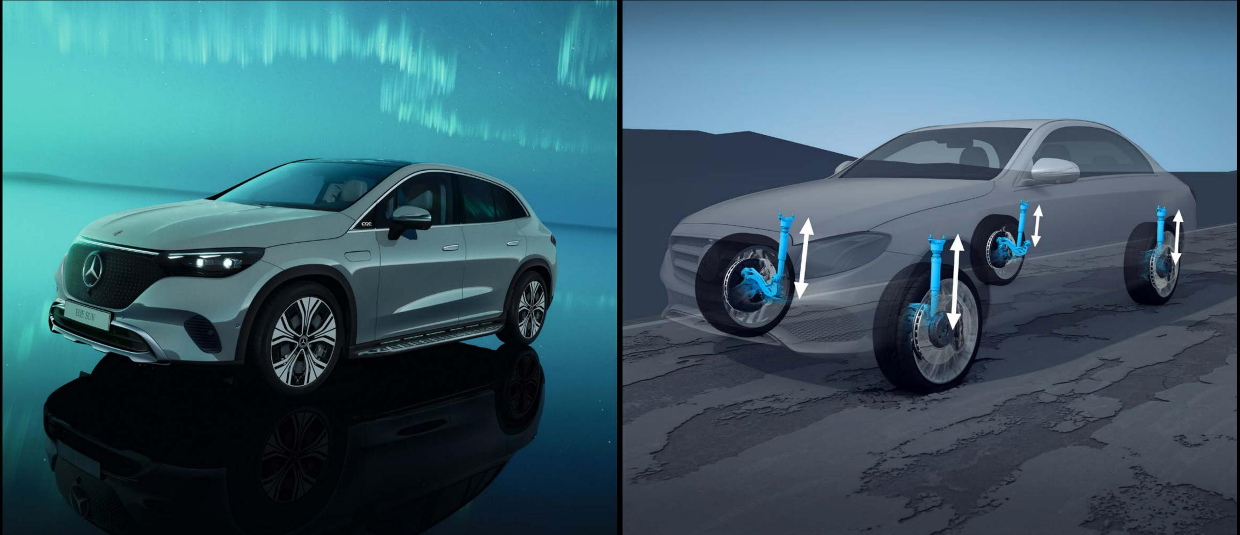
에어매틱 에어 서스펜션은 거친 노면에서도 탁월한 승차감을 제공합니다. 각각의 휠을 개별 조정할 수 있으며, 정교한 센서를 통해 노면 상황이나 차량 속도, 하중에 따라 서스펜션을 자동으로 조절합니다. 특히 고속 주행 시 에어 서스펜션을 낮춰 핸들링을 향상시키고, 바람의 저항력을 줄여 역동적인 드라이빙이 가능하도록 지원합니다. 또한, 필요에 따라 서스펜션을 올려 경사로 또는 험로 주행 전 지상고를 높일 수 있습니다. (기본사양)
