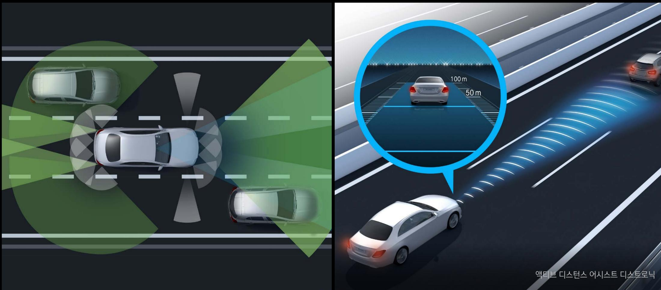
카메라, 레이더 및 초음파로 구성된 센서 시스템이 주변 환경을 분석하여 속도, 조향 제어 및 차간 거리 유지 등 필요 시점에 적합한 주행 보조 기능을 실행합니다. 코너, 원형 교차로, 나들목 또는 톨게이트 등의 환경을 고려하면서 이동하는 트래픽에 따라 운전자를 대신하여 제동 및 가속을 제어합니다. 충돌 위험이 있는 경우 먼저 시청각적 경고로 운전자에게 알리고, 필요시 자동으로 제동 기능을 실행합니다. (기본사양)
