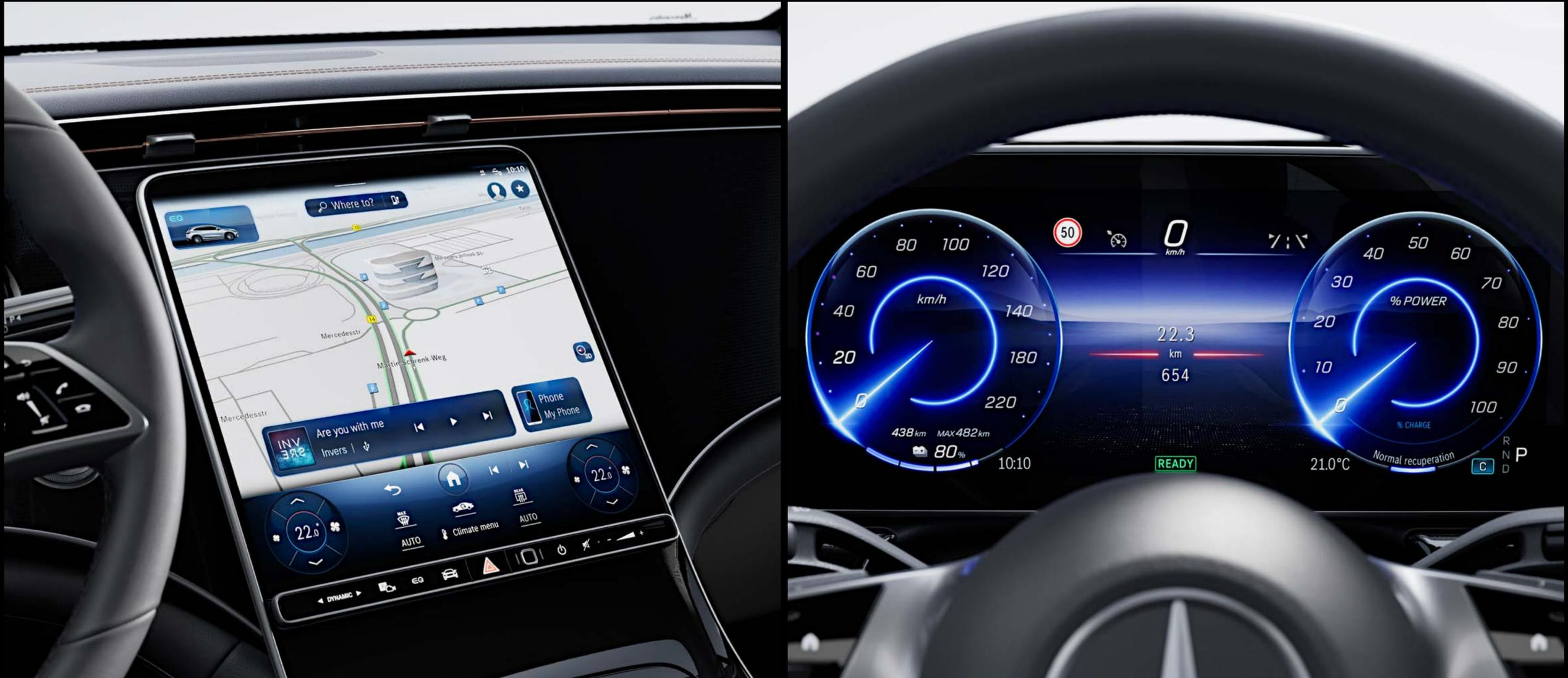
더욱 화려해진 고해상도 디스플레이로 다양한 미디어 시스템 이용이 가능합니다. 개별 조절이 가능한 12.3인치 와이드스크린 콕핏을 통해 주요 운전 정보를 편리하게 확인하고, 12.8인치 OLED 센트럴 디스플레이를 터치하여 온도, 조명, 내비게이션 등 다양한 MBUX 멀티미디어 시스템을 직관적으로 제어할 수 있습니다. 또한, 디스플레이 내 제로 레이어 인터페이스가 탑재되어 직접 메뉴를 선택하거나 변경하지 않아도 주변 도로 상황과 사용자의 행동 변화를 감지하여 실시간 정보 업데이트 또는 주행 상황에 적절한 콘텐츠를 추천합니다.
