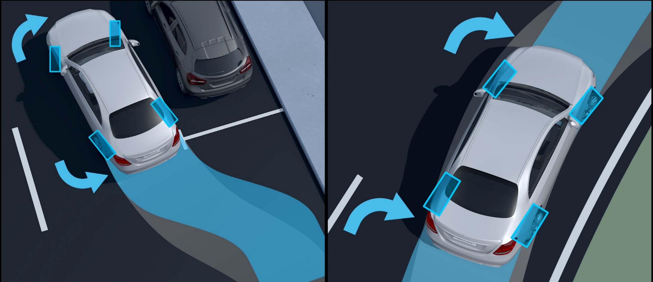
최대 조향각이 10°인 리어 액슬 스티어링은 회전 반경을 감소시켜 민첩한 핸들링이 가능하게 합니다. 또한, 프론트 액슬과 리어 액슬이 상호 작용하여 시내 또는 시골길 주행 시 최소한의 조향으로도 구동이 가능하도록 설계되었습니다. 60km/h 미만의 속도에서는 뒷바퀴가 앞바퀴와 반대 방향으로 최대 10° 까지 조향되며, 이를 통해 차량의 기동성이 향상됩니다. 특히 회전하거나 빠른 방향 전환 또는 천천히 움직일 때 효과적으로 반응합니다. 또한, 60km/h를 초과할 경우 뒷바퀴는 앞바퀴와 동일한 방향으로 최대 2.5°까지 조향합니다. 이에 따라 고속 주행 시 안정성 있는 핸들링과 전반적인 안전성을 향상시켜 주어, 빠른 차선 변경 또는 회피 기동 시에도 안전하게 주행할 수 있습니다.
