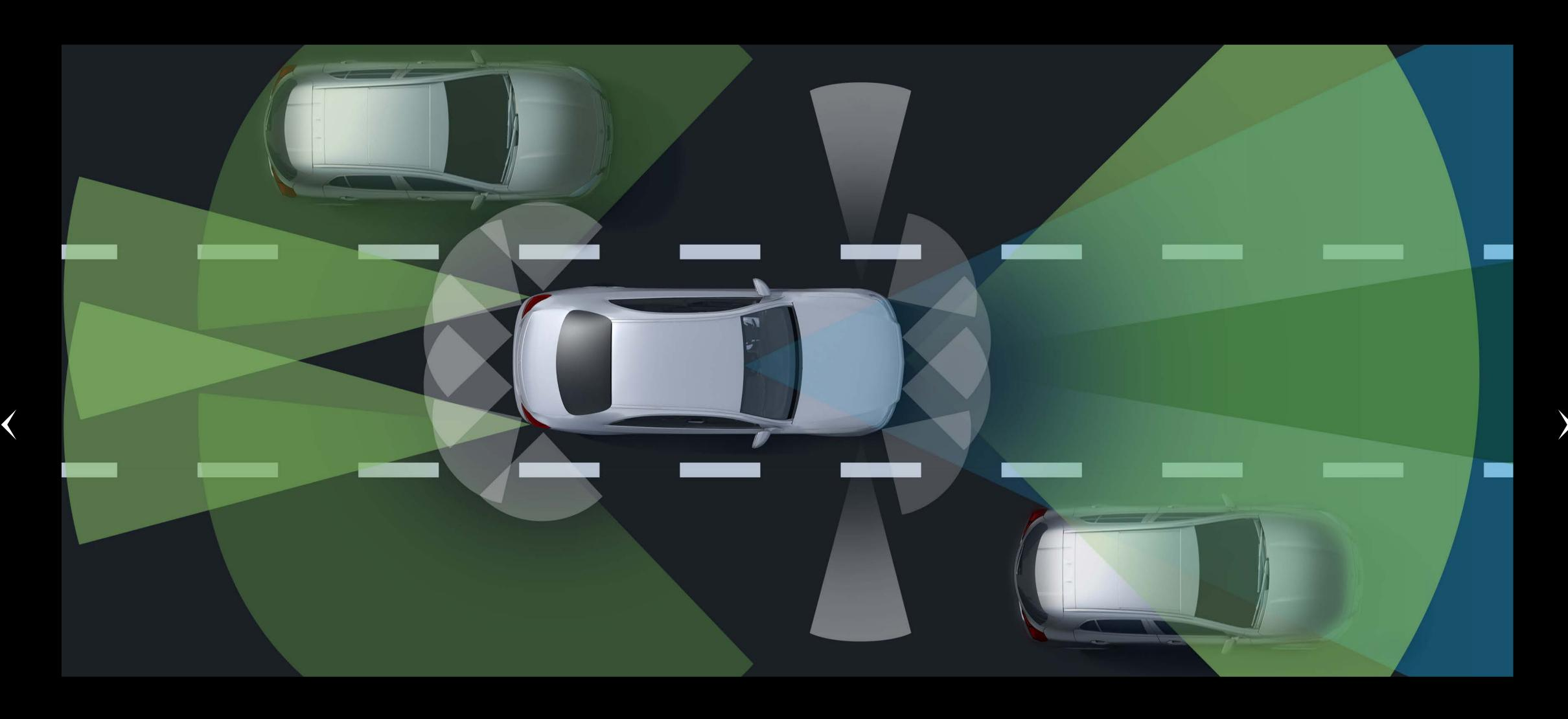
카메라, 레이더 및 초음파로 구성된 센서 시스템이 주변 환경을 분석하여 속도, 조향 제어 및 차간 거리 유지 등 필요 시점에 적합한 주행 보조 기능을 실행합니다. 코너, 원형 교차로, 나들목 또는 톨게이트 등의 환경을 고려하면서 이동하는 트래픽에 따라 운전자를 대신하여 제동 및 가속을 제어합니다. 충돌 위험이 있는 경우 먼저 시청각적 경고로 운전자에게 알리고, 필요시 자동으로 제동 기능을 실행합니다. 또한, 고속도로 혹은 차선 표시가 있는 일반 도로에서 차선을 벗어나는 경우 차량 방향을 수정하기 위해 시스템이 조향에 개입해 탑승자와 보행자를 보호하여 사고 위험을 줄일 수 있도록 도움을 줍니다. (기본사양)
