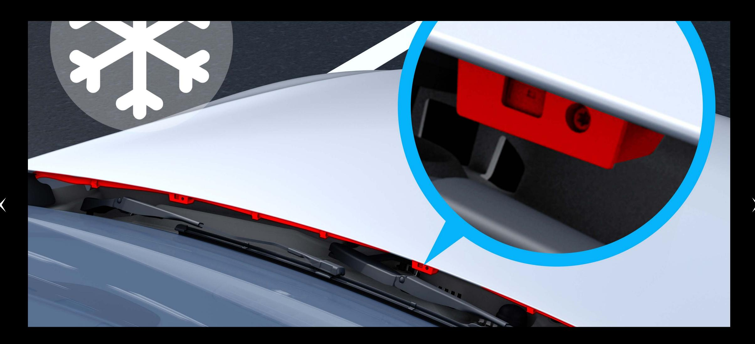
온열 윈드스크린 워셔 시스템은 추운 날씨에도 선명한 시야와 안전한 운전을 보장합니다. 특히 5°C 이하의 온도에서 에너지 효율적인 모드로 작동하며 앞유리를 결빙 현상이 발생 하지 않는 최상의 상태로 유지 시켜줍니다. (기본사양)
