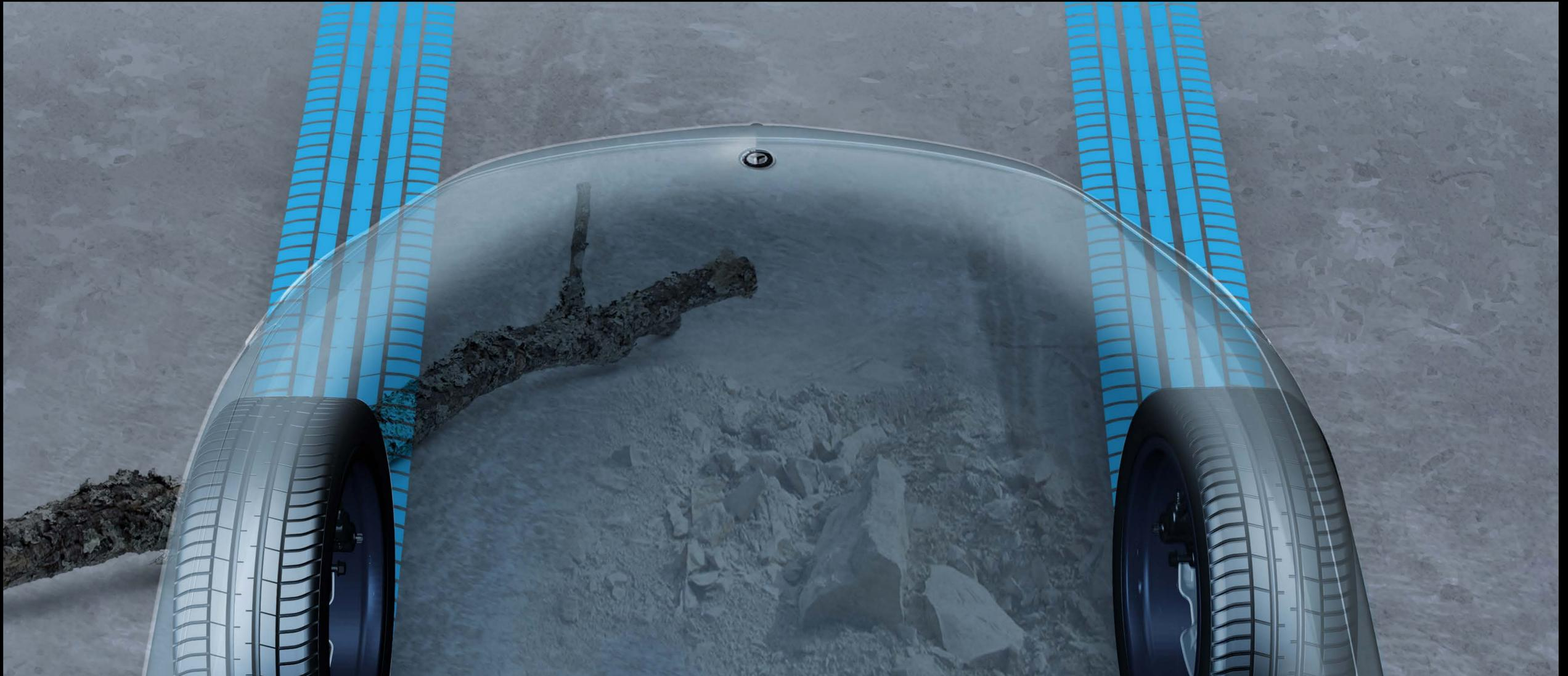
투명 보닛을 통해 역동적인 드라이빙의 즐거움을 더해보세요. 오프로드 모드 활성화 시 360° 카메라와 연계하여 중앙 디스플레이에 앞바퀴와 조향 위치를 포함한 차량 전면 아래의 실시간 가상 뷰를 제공합니다. 이를 통해 운전자는 경로에 있는 큰 돌이나 깊은 움푹 패인 곳과 같은 장애물을 조기에 인식할 수 있으며 최적의 주행 경로를 선택할 수 있습니다.
