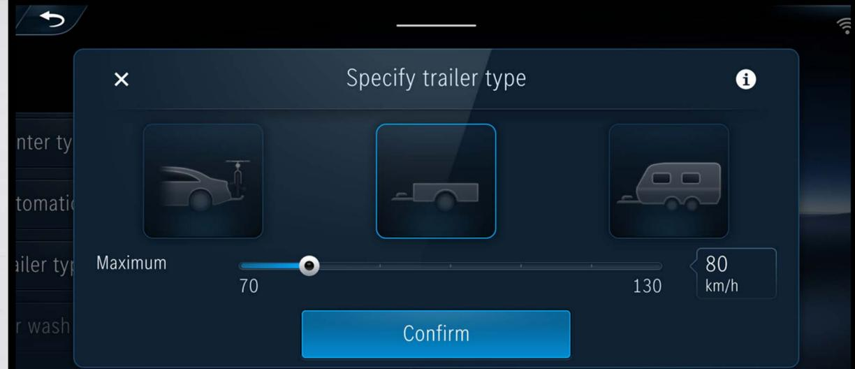
The new GLE 와 The new GLE Coupé에는 ESP® 트레일러 안정화 기능을 포함한 트레일러 커플링이 옵션으로 제공되어 차체에 트레일러를 장착할 수 있습니다. ESP® 트레일러 안정화 기능은 위급한 상황에 자동 개입하며, 65km/h 이상으로 주행 시 갑작스러운 흔들림을 감지하면 각각의 휠에 제동을 걸어 진동을 줄입니다. 또한, 필요한 경우 엔진 토크를 줄이고 4개 휠에 브레이크를 걸어 차량의 속도까지 낮춥니다.
