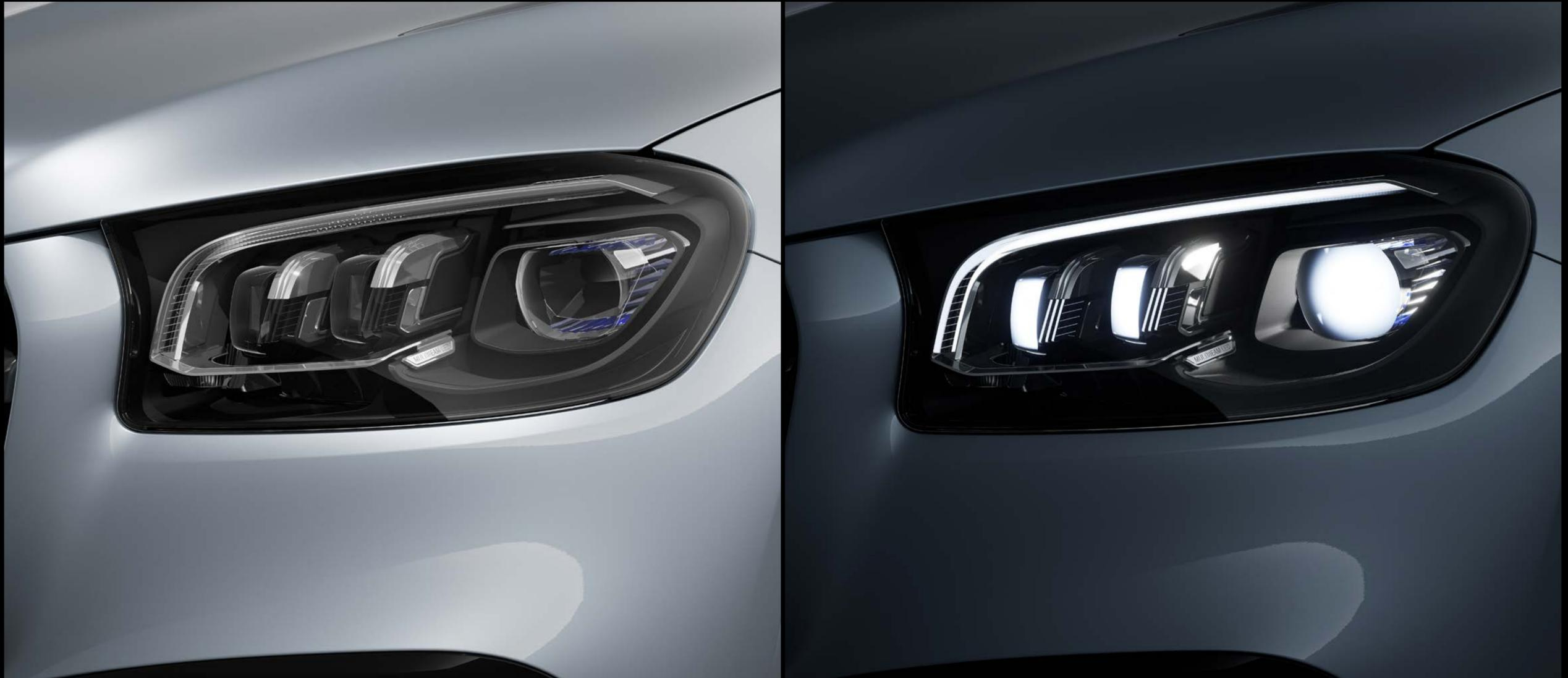
개별 조절 가능한 LED가 장착된 적응형 멀티빔 LED 헤드램프는 교통 상황에 따라 반응합니다. 메인 빔은 반대편 도로에서 주행하는 차량을 비추지 않기 때문에 상대 차량 운전자의 눈부심을 최소화합니다. 다른 차량의 불빛이 없을 경우 울트라 레인지 하이빔이 미치는 거리는 증가합니다. 코너링 라이트 및 액티브 라이트 기능도 시야를 충분히 확보해 줍니다.
