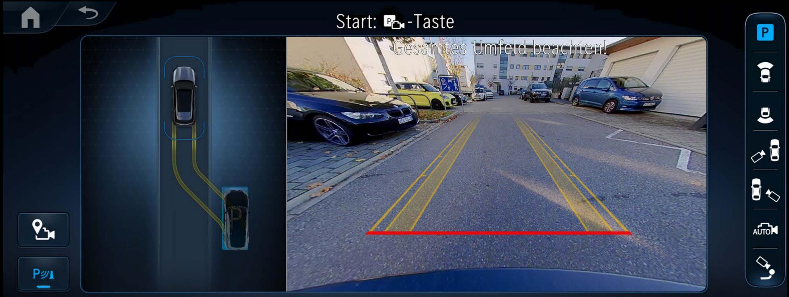
360° 모니터링 기능을 제공하는 주차 서비스를 경험해보세요. 360° 카메라가 탑재된 액티브 주차 어시스트 파크트로닉이 비어 있는 주차 위치나 표시된 주차 공간을 감지합니다. 차량 방향과 버드뷰 화면을 통해 주차 및 출차가 편리해집니다. (기본사양)
