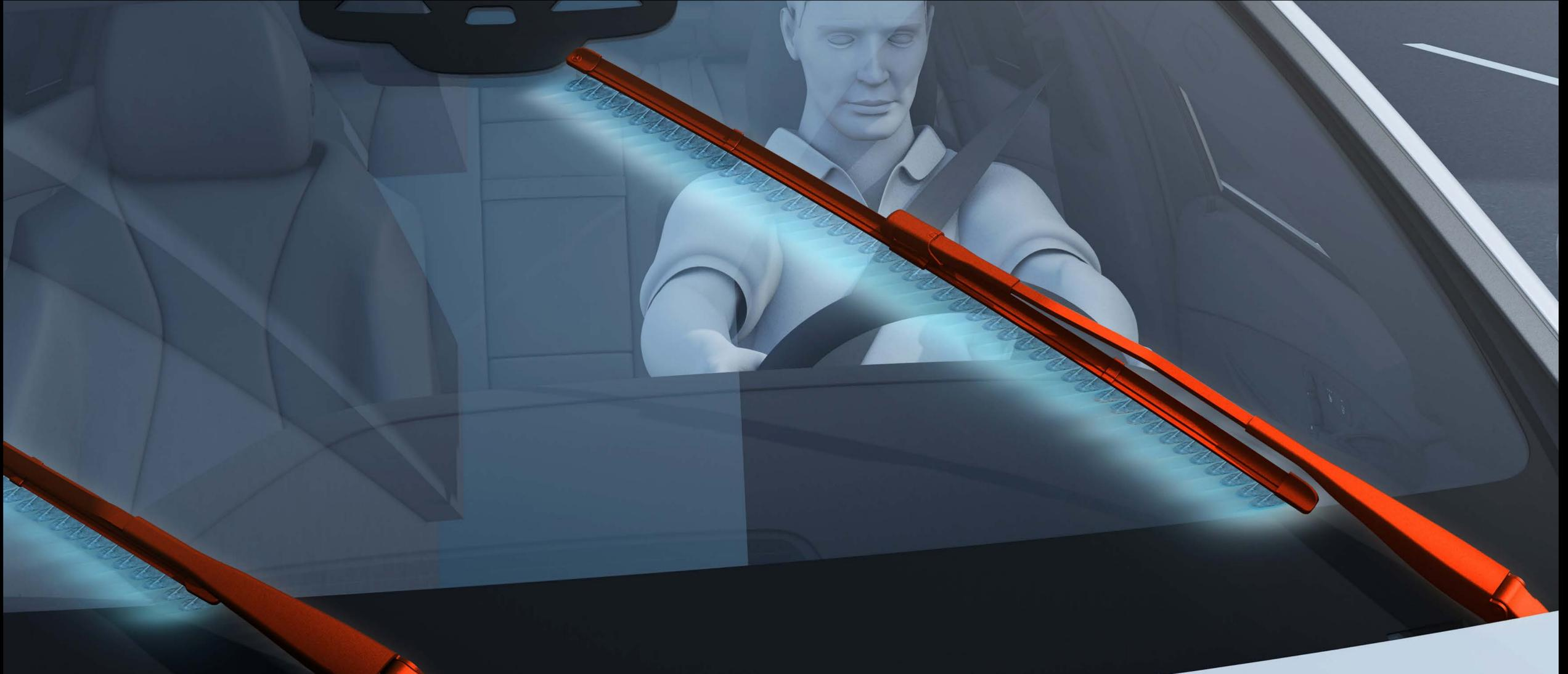
매직 비전 컨트롤은 차량의 주행 속도 또는 외부 온도 등의 다양한 주행 상황에 따라 와이퍼 날에서 직접 분사되는 물과 워셔액의 양을 조절하여 운전자가 시야를 확보할 수 있도록 지원합니다. 선루프를 개방한 상태로 주행할 경우, 분사되는 물의 양을 최소화하는 동시에 분사 방향을 아래로 조정하여 차량 내부로 물이 튀어 들어오는 것을 방지하며, 이로써 워셔액 사용량을 최대 50%까지 절감하는 효과를 볼 수 있습니다. 뿐만 아니라, 외부 온도가 영하일 경우 열선이 내장된 와이퍼 블레이드로 앞 유리에 눈이 쌓이는 것을 방지하여 와이퍼 작동 성능을 향상시키며, 레인 센서를 통해 오염 정도를 감지하여 세척이 필요한 곳에 워셔액을 집중적으로 분사하여 앞유리를 더욱 효율적으로 닦아냅니다. (기본사양)
