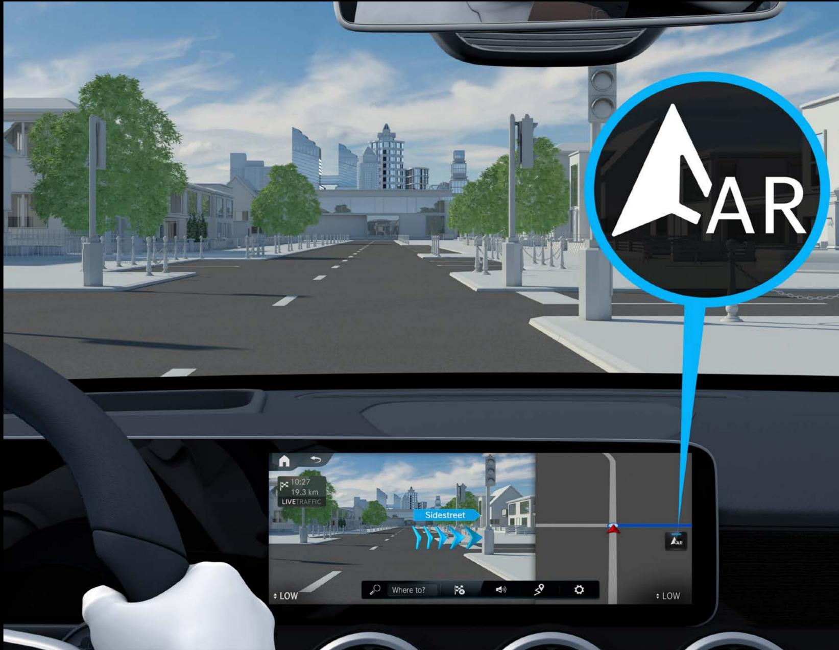
MBUX 증강 현실 내비게이션은 그래픽 내비게이션과 실시간 교통 정보가 통합되어 안전하고 편리하게 목적지에 도달할 수 있도록 도와줍니다. 차량 전면부에 장착된 카메라가 내비게이션과 연동되어 미디어 디스플레이를 통해 도로명과 길안내를 표시합니다. (기본사양)
