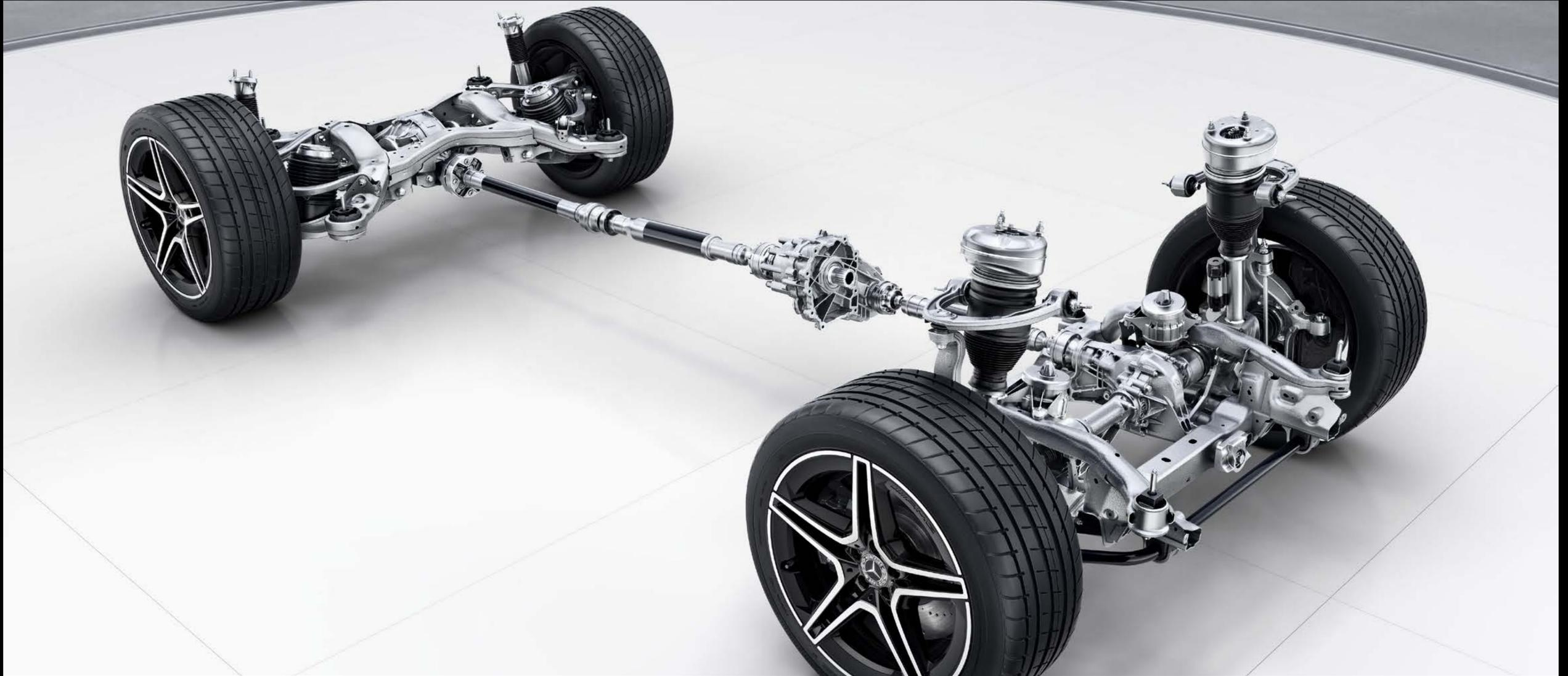
에어매틱 에어 서스펜션은 거친 노면에서도 탁월한 승차감을 제공합니다. 각각의 휠을 개별 조정할 수 있으며, 정교한 센서를 통해 노면 상황이나 차량 속도, 하중에 따라 서스펜션을 자동으로 조절합니다. 특히 고속 주행 또는 다이내믹 셀렉트 'Sport', 'Sport +' 모드 선택 시 자동으로 서스펜션을 낮춰줍니다. 이를 통해 낮아진 바람 저항력으로 안정적이고 역동적인 주행이 가능하여 드라이빙에 즐거움을 더할 수 있습니다. 또한, 필요에 따라 서스펜션을 올려 경사로 또는 험로 주행 전 지상고를 높을 수 있습니다. (기본사양)
