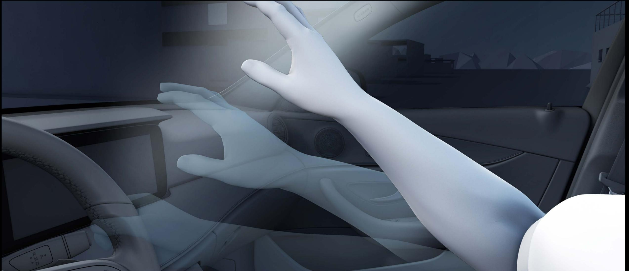
MBUX 인테리어 어시스턴트는 오버헤드 컨트롤 패널에 장착된 3D 카메라 시스템을 통해 운전자를 비롯한 앞좌석 탑승자의 움직임을 분석하여 그에 맞는 기능을 제공합니다. 손과 팔의 움직임, 손이 다가오는 시점을 식별하여 빠른 기능 액세스를 통해 운전자 및 조수석 동승자가 서치라이트 및 다양한 기능들을 쉽게 이용할 수 있도록 도와줍니다. 또한, MBUX 스크린을 직접 터치하지 않고도 미리 설정한 손동작을 취하는 것만으로 MBUX의 즐거움을 불러올 수 있으며, 독서등, 선루프, 시트 등을 간편하게 컨트롤할 수 있습니다. (기본사양)
