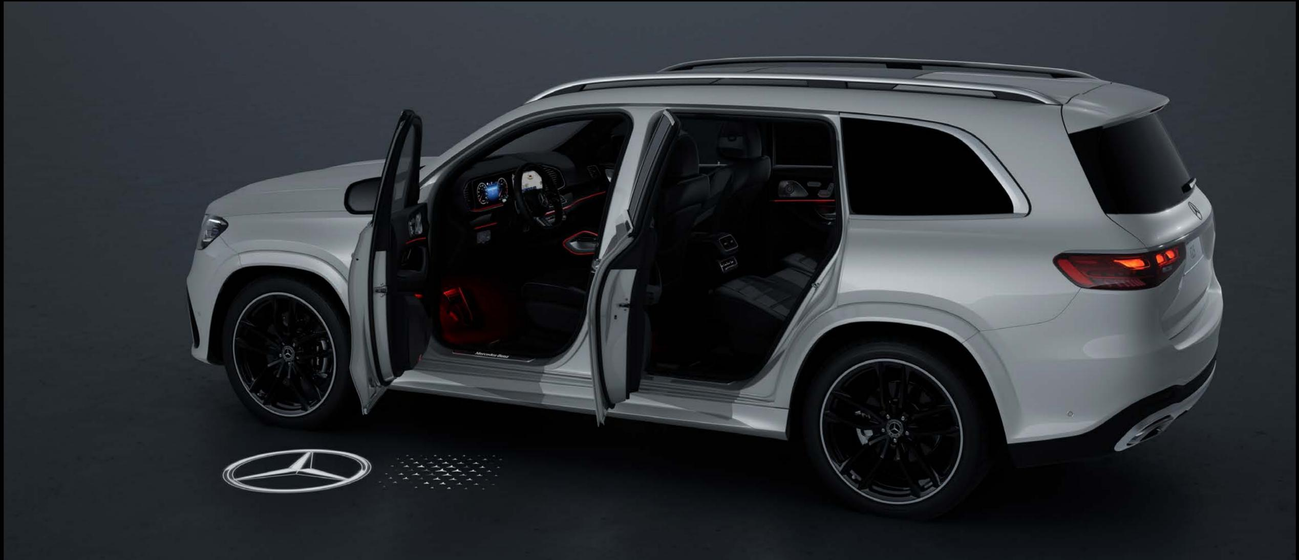
두개의 LCD 프로젝터를 통해 운전석과 조수석 입구 영역에 Mercedes-Benz 애니메이션 로고를 투사합니다. 이를 통해 어두운 곳에서도 주변의 시선을 사로잡으며 편리하고 안전하게 차량 승하차가 가능합니다. (기본사양)
