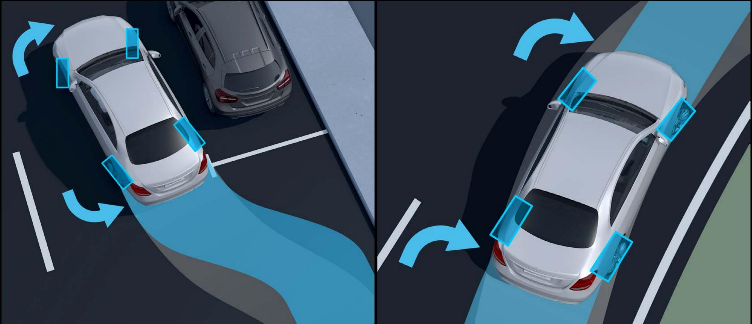
최대 조향각이 10°인 리어 액슬 스티어링으로 회전 반경이 최대 2m까지 감소되어 조작성이 쉬워지고, 고속주행 시에는 긴 휠베이스를 통해 수월하게 드라이빙 할 수 있습니다. 60km/h 미만의 속도에서 뒷바퀴는 최대 10°까지 앞바퀴의 반대 방향으로 조향 할 수 있으며 휠베이스가 짧아져 차량의 민첩성과 기동성이 향상됩니다. 60km/h를 초과할 경우 뒷바퀴는 앞바퀴와 동일한 방향으로 최대 3°까지 조향 되어 휠베이스가 확장되고, 고속 주행 및 차선 변경, 긴급 상황에서의 회피 기능 등 주행 안정성과 핸들링 안전성이 높아집니다. 또한, 좁은 골목길에서도 최소한의 움직임으로 민첩하게 핸들링이 가능합니다. 이 기능은 ESP®에 통합된 다이내믹 핸들링 컨트롤 시스템을 통해 구현됩니다. (기본사양)
