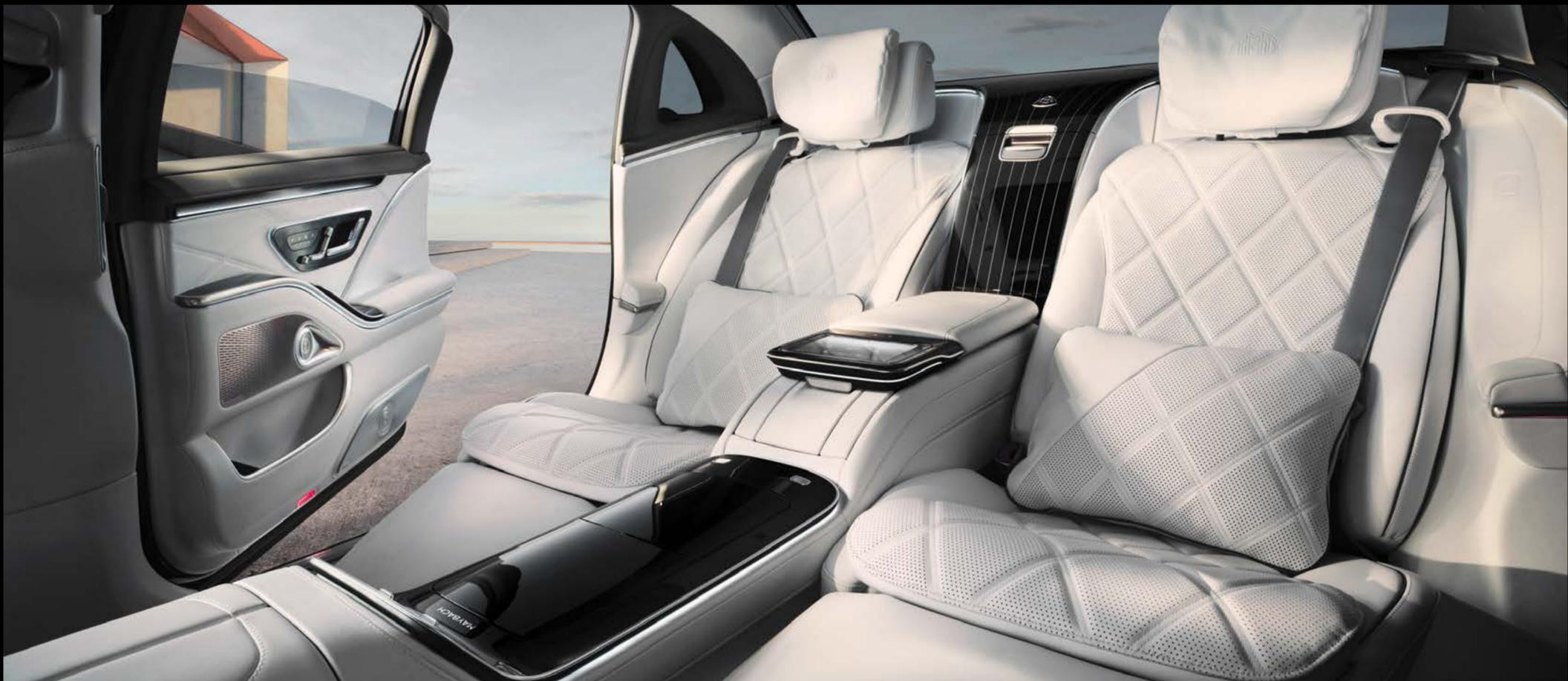
뒷좌석에 앉는 순간 멀티컨투어 시트가 적용된 최적의 시트 포지션으로 최상의 안락함을 경험하실 수 있습니다. 6방향으로 작동되는 뒷좌석 헤드레스트 쿠션에는 목, 어깨 히팅 기능이 내장 되어 있으며, 전방과 후방, 높이와 기울기 등을 조정할 수 있습니다. 뿐만 아니라 다양한 마사지 프로그램으로 탑승자가 긴장을 완화하거나 최상의 컨디션으로 리프레싱 할 수 있도록 도움을 줍니다. 주행 중 위급한 상황이 감지될 경우에는 PRE-SAFE® 시스템을 통해 멀티 컨투어 시트 내의 에어 챔버 압력을 높여 탑승자를 좌석에 밀착시켜 충격을 최대한 완화합니다. (기본사양)
