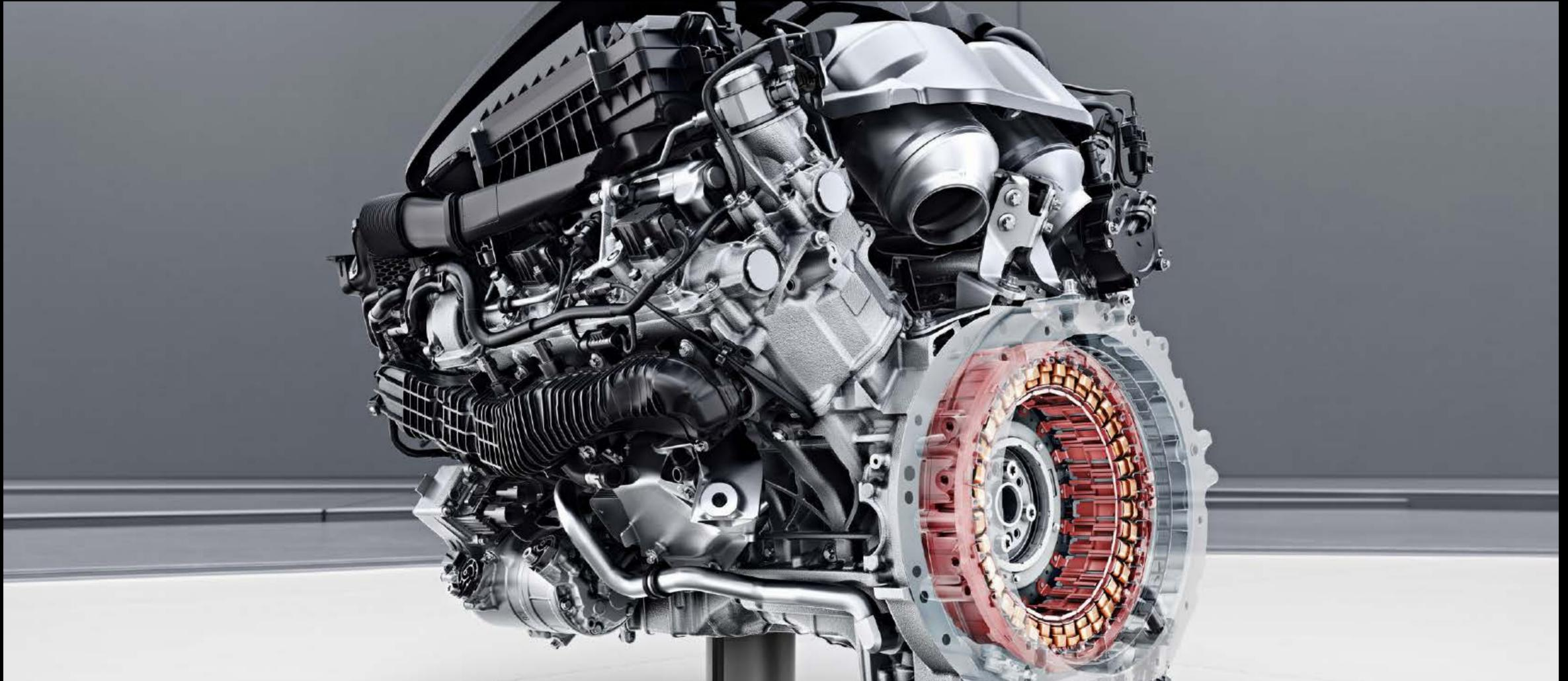
이너-V(inner-V)에 위치한 두 개의 터보차저, ISG 및 지능형 실린더 차단 기능에 체계적인 전동화 기술이 더해져 최상의 성능과 최대 효율을 구현합니다. 우수 합금과 NANOSLIDE® 기술이 적용된 실린더 헤드 및 실린더 배럴이 파워 패키지를 완성합니다.
