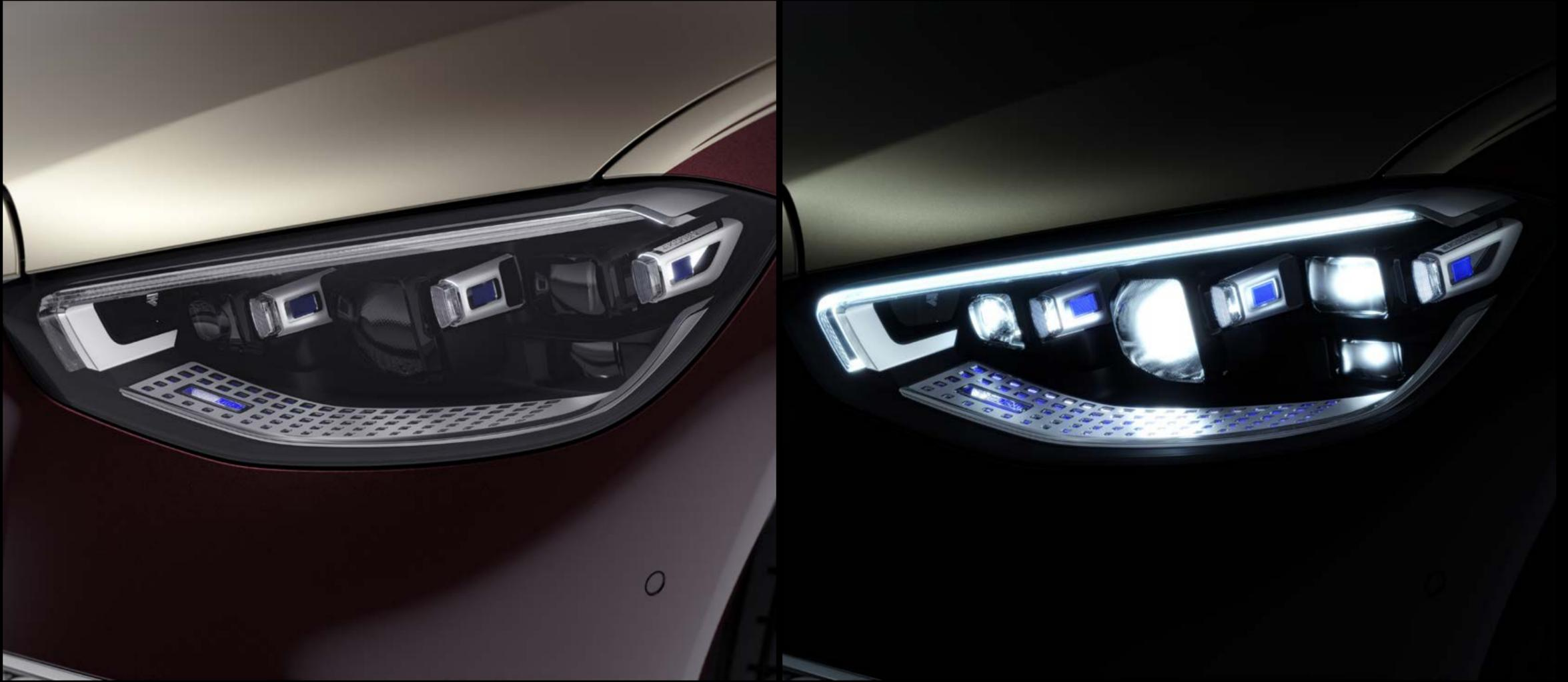
디지털 라이트는 헤드램프당 130만 픽셀로 이루어진 프로젝션 모듈과 84개의 고성능 멀티빔 LED 모듈이 적용된 HD 시스템이 탑재되어 더욱 선도적인 기술로 운전자를 지원합니다. 카메라와 센서, 내비게이션을 통해 실시간으로 수집된 데이터를 바탕으로 개별 헤드램프의 픽셀 밝기를 주행에 최적화되도록 조절합니다. 울트라 레인지 하이빔은 650m 범위까지 비추며, 주행하는 지형의 높낮이 변화에도 헤드램프 밝기가 일정하게 유지될 수 있도록 자동으로 조정합니다. 교차로 진입 시 코너링 기능이 자동 활성화되며, 안개등 기능뿐만 아니라 다양한 주행 모드에 따른 메인빔의 기능이 더욱 향상되었습니다. (기본사양)
