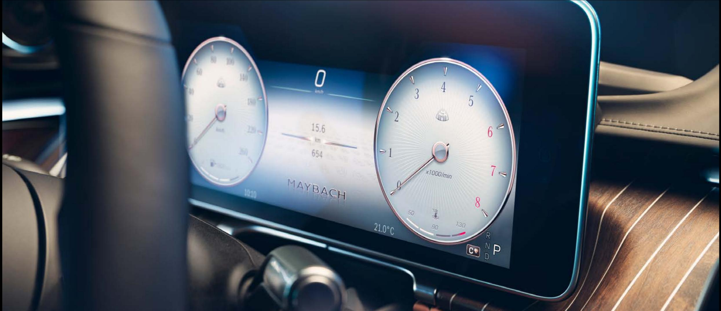
3D 계기반은 운전자의 취향에 맞게 다양한 디스플레이 스타일을 선택할 수 있습니다. 파란색 톤의 "Modern Classic"과 흰색 및 회색톤으로 이루어진 "Luxury"는 엔진 속도를 나타낼 때 클래식한 다이얼 기기를 연상시키는 2-튜브 디자인을 적용했습니다. "Discreet" 모드는 주행에 필요한 정보를 미니멀하게 표시합니다. 기본적인 주행 정보 뿐만 아니라, 드라이빙 어시스턴스 시스템의 알림이 3D 및 음영 효과를 통해 즉각적으로 눈에 띄며, 차량 앞의 자동차, 트럭, 버스 혹은 오토바이 또한 3D 이미지로 표현됩니다.
