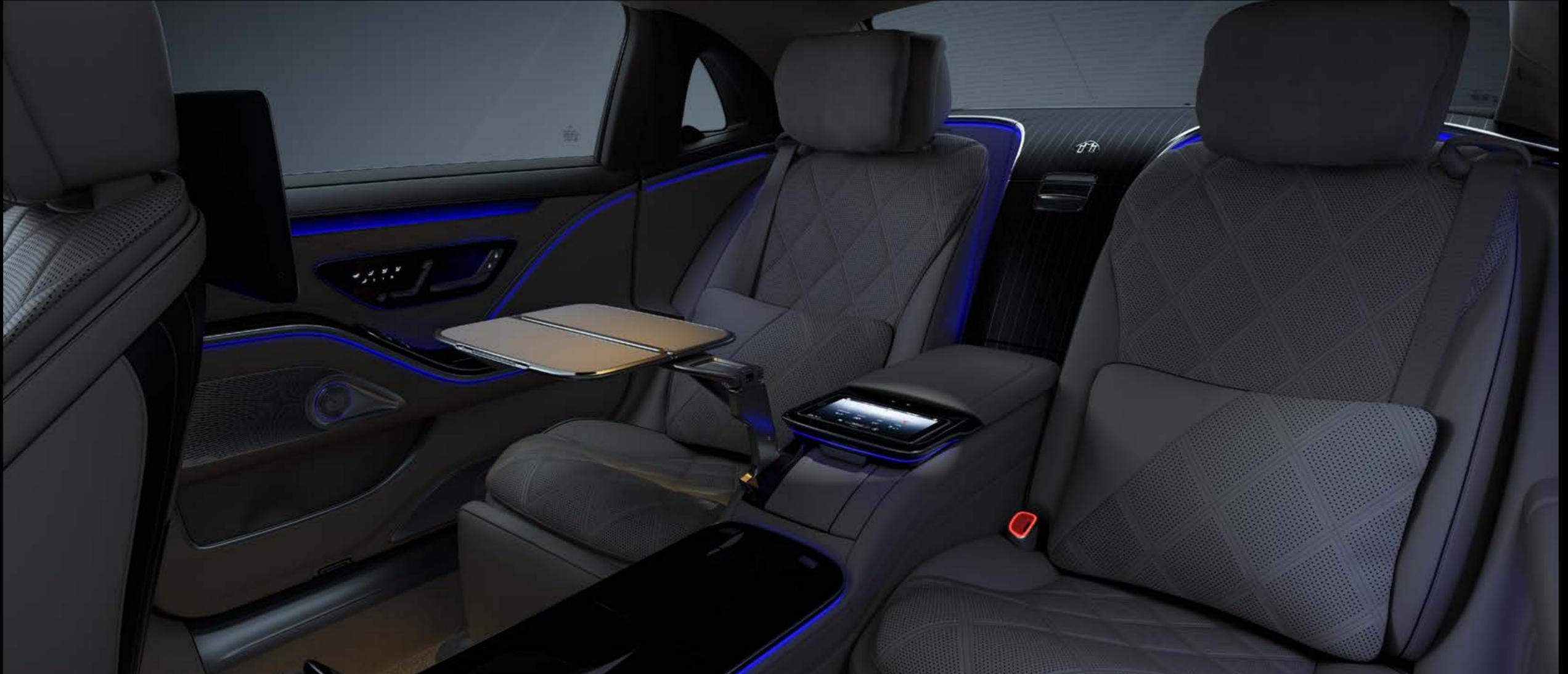
액티브 앰비언트 라이트를 통해 인테리어를 원하는 스타일과 분위기로 연출할 수 있습니다. 총 약 250개의 개별 작동식 LED가 장착된 고품질 블랙 패널 조명 스트립으로 64가지 컬러를 단일 또는 다중으로 디스플레이할 수 있습니다. 낮과 밤 시간에 따라 밝기가 자동으로 조절되며, 에너지이징 패키지와 함께 사용 시에는 선택한 프로그램에 따라 주변 조명도 함께 변경됩니다. 또한, 에어컨을 조정하거나 MBUX 음성 어시스턴트를 사용할 때에도 앰비언트 라이트의 컬러 및 밝기를 통해 상태를 시각적으로 표현하며, 주행 보조 시스템과 연동되어 액티브 사각지대 어시스트, 액티브 차선 유지 어시스트, 액티브 브레이크 어시스트 등의 기능 작동 시 운전자에게 시각적인 피드백을 전달합니다. (기본사양)
