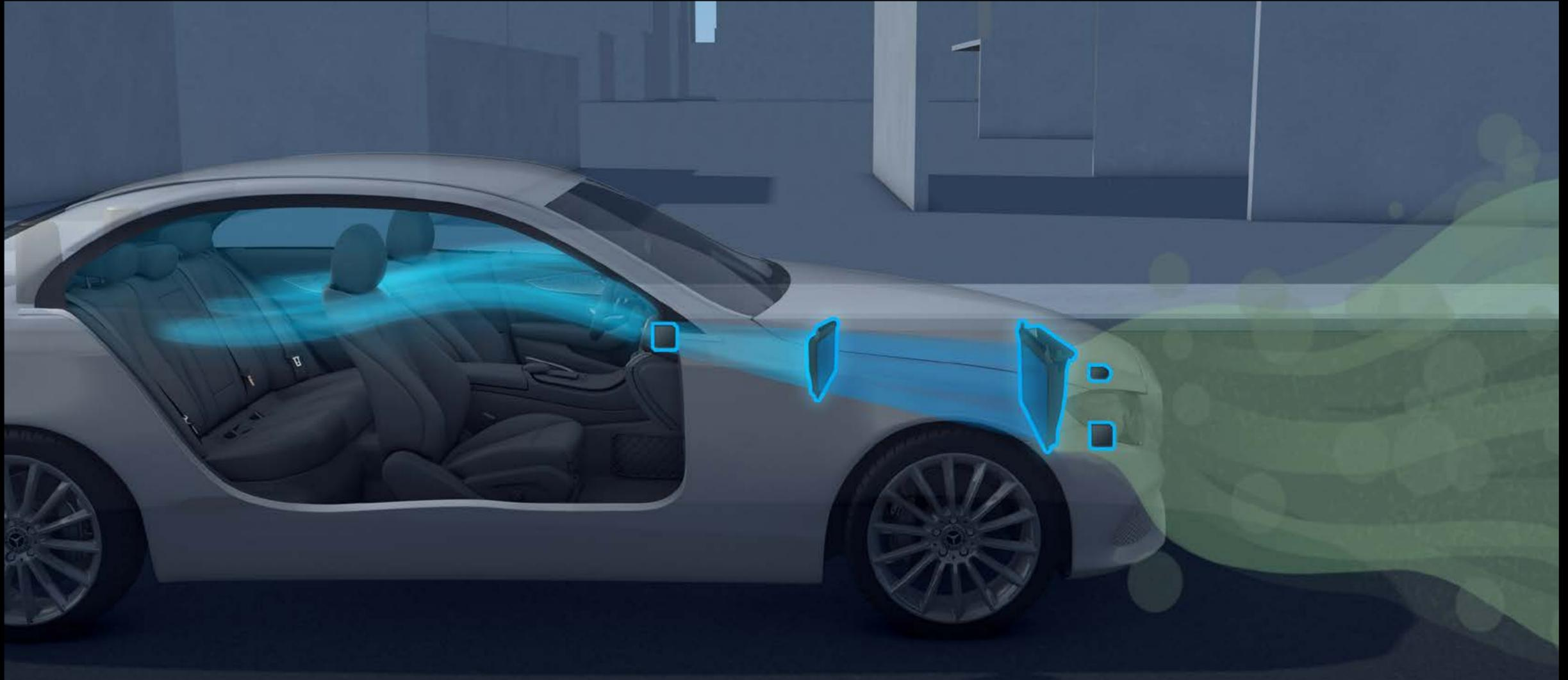
공기 청정 패키지는 차량 내부와 외부의 공기질을 모니터링하고 그 결과를 MBUX 멀티미디어 시스템으로 보여줍니다. 측정된 값이 특정 범위에 속하게 되면 쾌적한 실내 환경을 위해 순환 모드를 자동으로 전환합니다.
